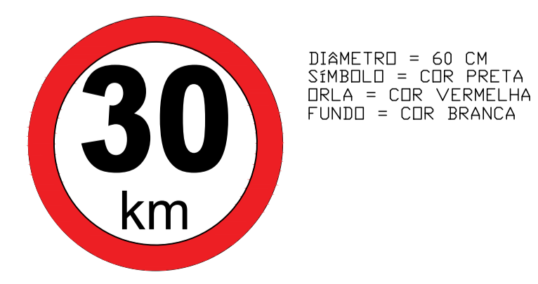
PLACA R-19 PLACA VELOC. PERMIT. 30 km
